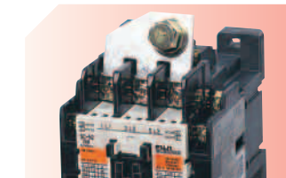
三相并列端子板 (SZ-SP□型) 将其安装于主电路端子后,可构成单相电阻性负载用电磁接触器。
