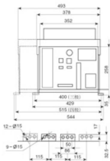
固定式断路器安装尺寸及外形尺寸( $I_{n}=3200A$ )
