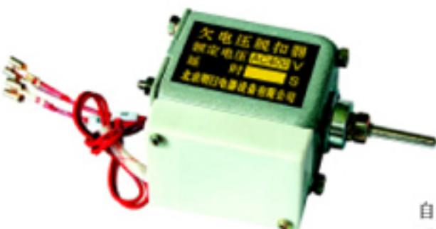
该装置在当电源电压低于其规定的工作电压值时自动使断路器断开。当工作电路电压低于其规定值时，具有瞬时和延时 1s, 2 s, 3s 脱扣，其延时时间根据用户需要选定。
