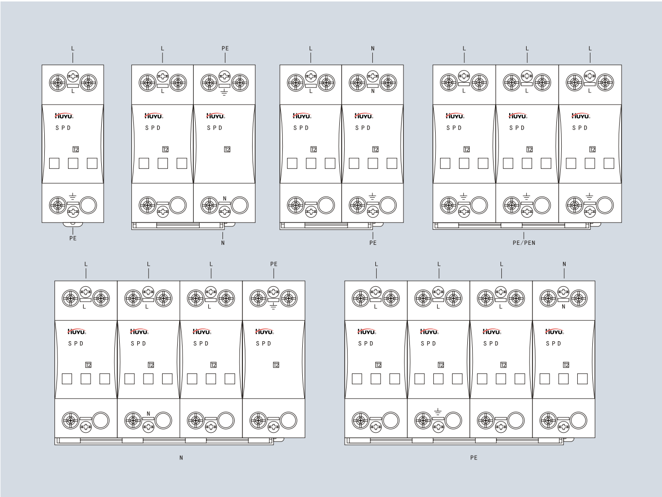
图 2、电涌保护器的接线型式
