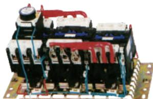
QJX2系列“星三角”减压起动器，适用于交流50Hz或60Hz，额定工作电压660V及以下，额定工作电流至95A下的电路中，对正常工作时为三角形接法的电机进行“星三角”转换减压起动以降低电动机的起动电流及对电网电压的影响。
