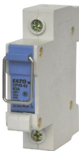
CFH5系列隔离开关(以下简称开关)适用于交流50Hz、额定电压230V(1P、2P)、400V(3P、4P)、额定电流至125A的电路中，主要供无负载情况下接通或断开电路，作为线路与电源接通或隔离之用。尤其适合线路检修时有效隔离电源并防止意外合闸，以确保检修人员的操作安全。
