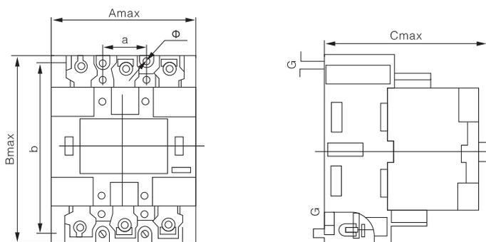
图4 CFC8-105、107、250、370接触器外形及安装尺寸
