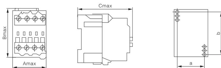
图2 CFC8-25、30接触器外形及安装尺寸
