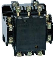
CFC10系列交流接触器适用于交流50Hz，额定工作电压380V，额定工作电流至150A及以下的电路中，作频繁地接通和分断电路及控制交流电动机的起动、停止之用，并可与适当的热过载继电器组成电磁起动器以保护可能发生过载的电路。
