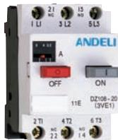
DZ108 系列塑料外壳式断路器适用于交流 50Hz 或 60Hz，额定电压至 380V 及以下，额定电流 0.1A 至 63A 的电路中。作为电动机的过载、短路保护之用。也可在配电网中作线路和电源设备的过载及短路保护之用。在正常情况下，亦可用作线路的不频繁转换及电动机的不频繁起动和转换之用。
