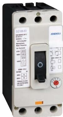
断路器具有双金属片式反时限限脱扣器和电磁式脱扣器。过载脱扣器具有温度补偿装置。
