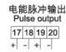
电能脉冲输出 Pulse output 脉冲1 脉冲2 (Pulse) (Pulse)
