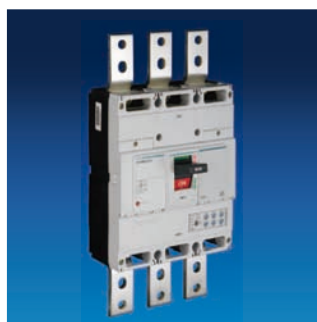
800A壳架 额定电流：800A 分断能力：50kA, 80kA 额定绝缘电压：690V
