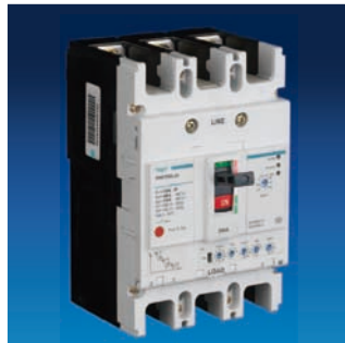
250A壳架 额定电流：250A 分断能力：50kA, 80kA 额定绝缘电压：690V
