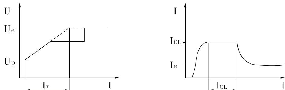
带有电压斜坡和限流的软起动
