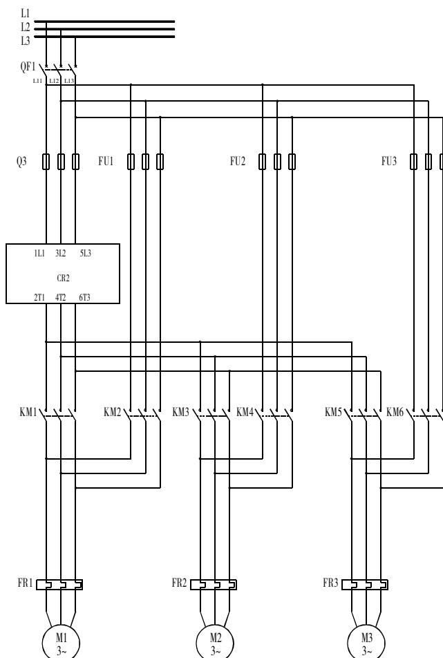
注：本图适用于一台CR2软起动器控制三台电机分时起动。在这种方式下，软起动器的软停止功能不能用；同时必须另选过载保护元件。
