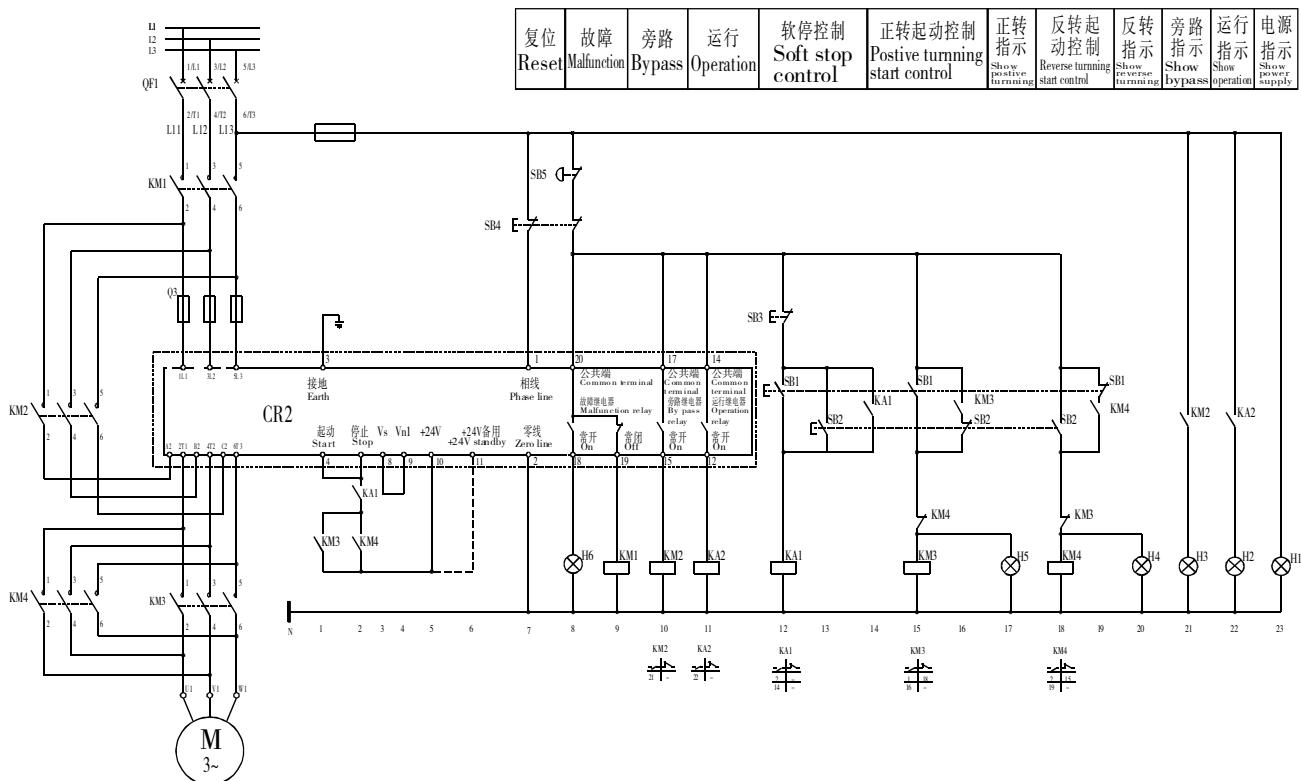
注:必须在电机完全停止后才能进行相反方向的运行,否则会损坏电机及生产设备.
