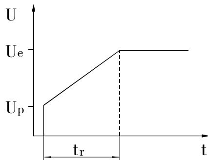
带有电压斜坡的软起动
