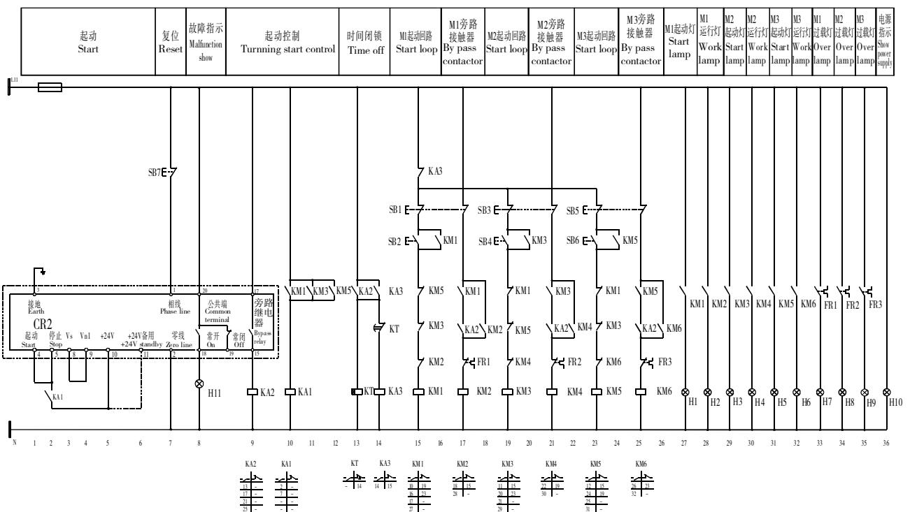
注：时间闭锁回路用于控制软起动器每小时的起动次数，时间继电器KT的设定值为5min。
