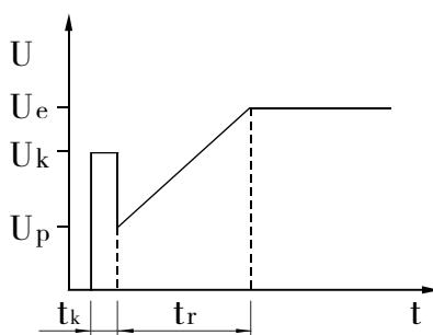
带有突跳、电压斜坡的软起动
