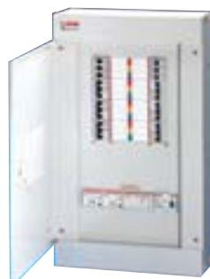
SDB系列直排结构配电箱的设计符合GB 7251.3 - 1997 及 GB 17466 - 1998标准，它可以配用如负荷开关、漏电保护器、塑壳开关、以及其他DIN导轨安装组件或用于电缆直接连接的进线装置。主母线额定电流为 160A。
