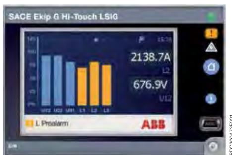
在脱扣器前端还有两个 LED：1 个预报警 LED（黄色，正方形）和 1 个报警 LED（红色，三角形）。LED 闪烁时，显示器同时还会显示相应信息，以便清楚识别事件类型。只需轻轻触摸一下报警区底部左侧的白色条形区，便可以查看当时所有激活的报警列表。
