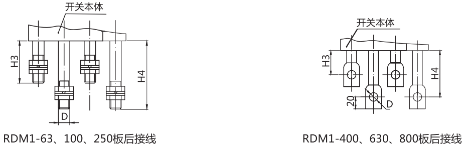
图8 RDM1系列板后接线外形及安装尺寸
