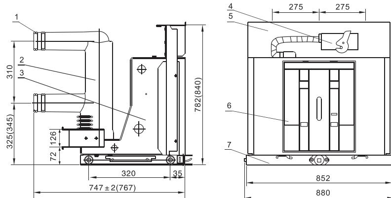
1、梅花触头 2、真空灭弧室极柱 3、机构框架 4、GDZ-58航空插头
