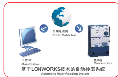
基于LONWORKS技术的自动抄表系统 Automatic Meter Reading System
