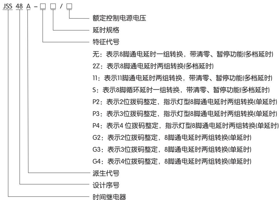
注: 本产品部分型号适用于宽范围工作电压, 如工作电压在AC/DC24V~48V表示交直流24V至48V的电压范围内都可以正常工作。
